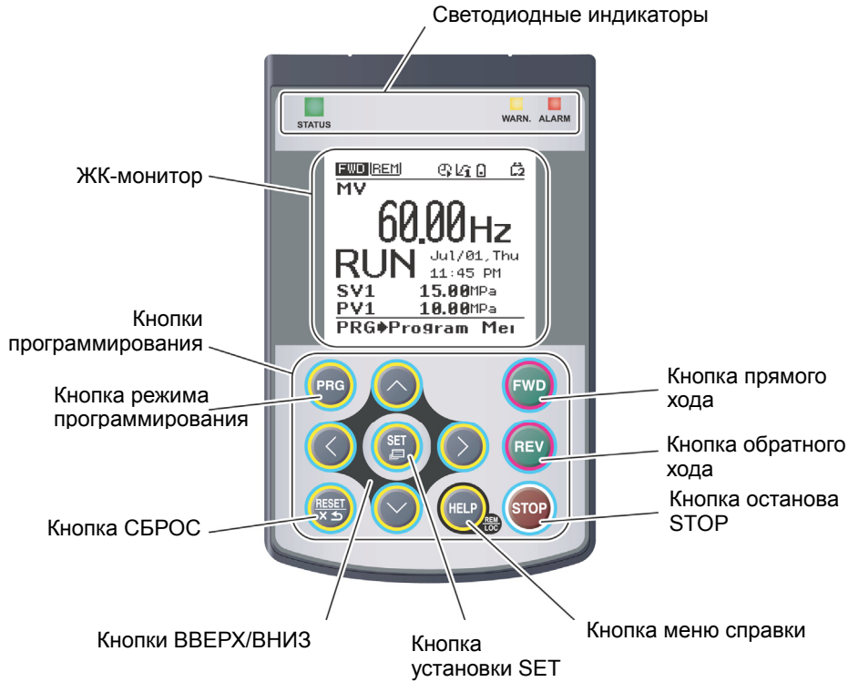
Рисунок 5.11 Наименования и функции компонентов панели управления
